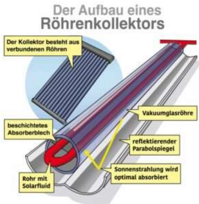
Abbildung 27: Aufbau eines Röhrenkollektors
