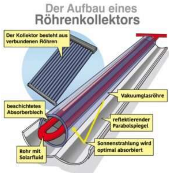
Abbildung 27: Aufbau eines Röhrenkollektors
